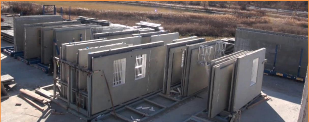
Les Armacoffrés® sont fabriqués en usine dans un carrousel.
