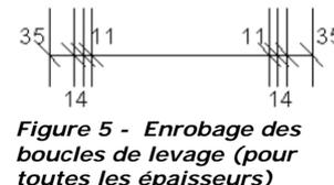
Figure 5 - Enrobage des boucles de levage (pour toutes les épaisseurs)
