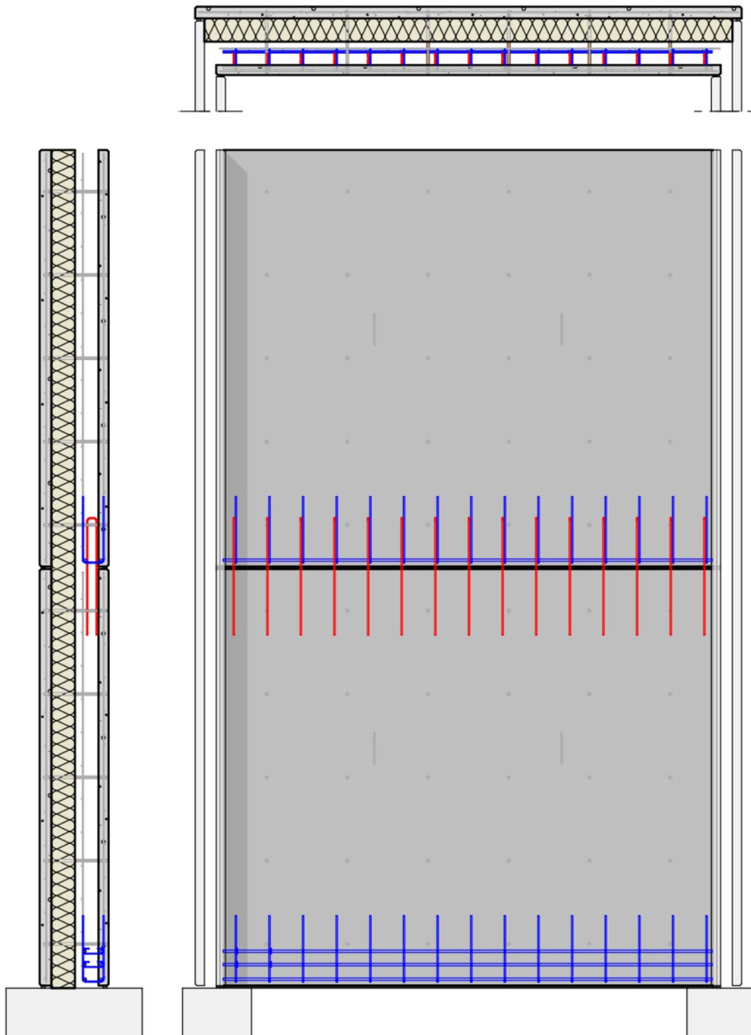
Figure 78 : poutre-voile en plusieurs éléments superposés
