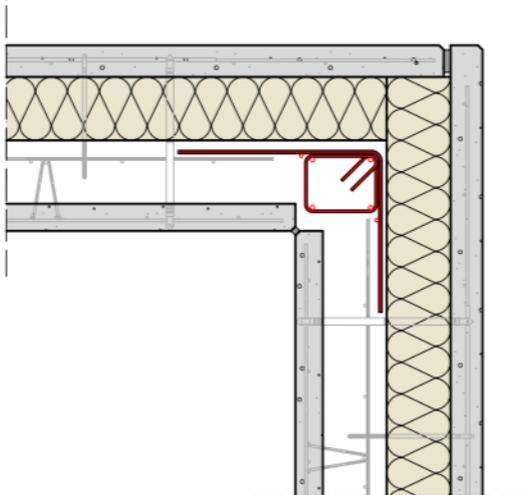
**Figure 46 : Liaison d'angle en zone sismique avec chaînage**
