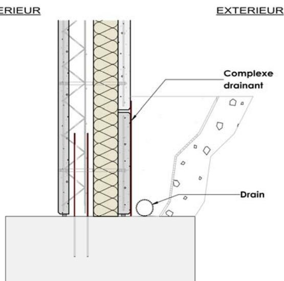
Figure 68 : drainage des mur semi-enterrés
