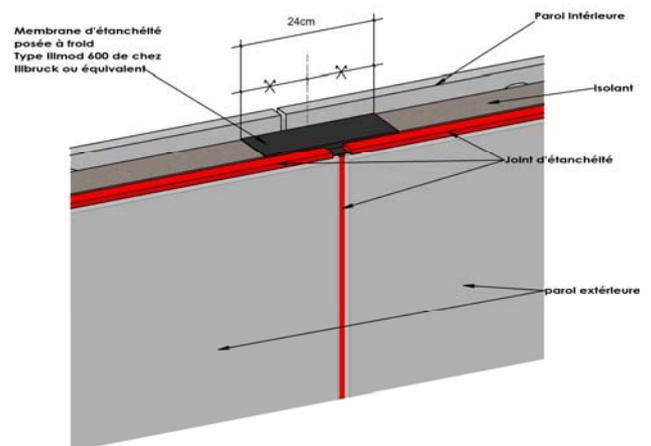
Figure 67 : Détails sur joints horizontaux : paroi extérieure au niveau de l'arase supérieure du plancher
