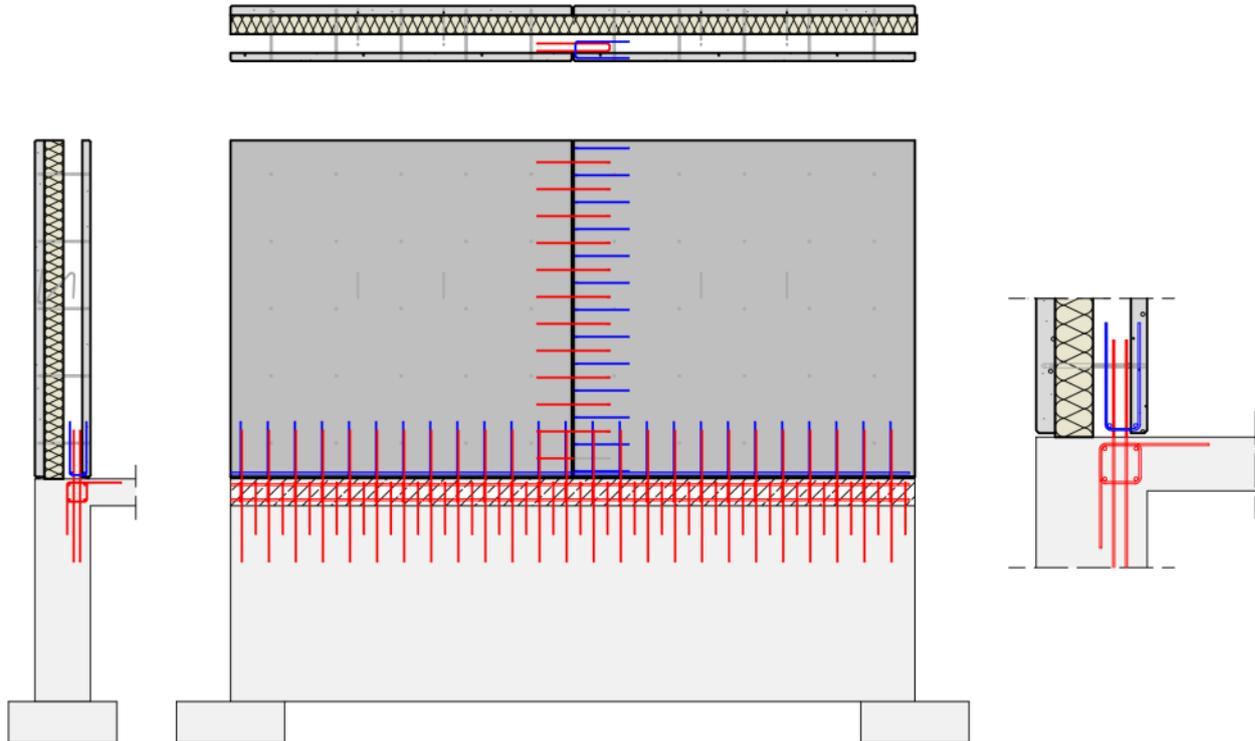
Figure 82 : poutre-voile réalisée en 2 parties
