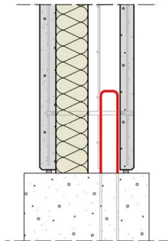
Figure 22 : principe de liaison articulée pour l'(i)Premur A2C
