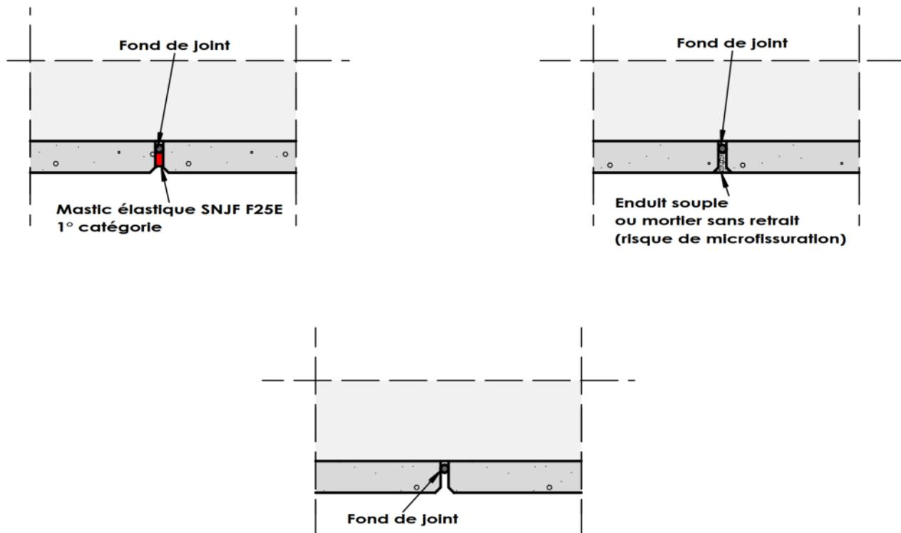
Figure 69 : Traitement du joint INTERIEUR entre (i)Premur A2C
