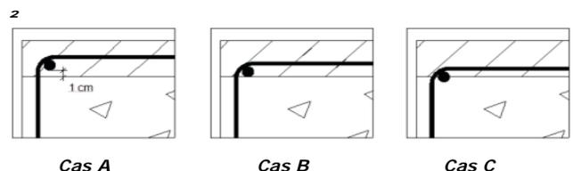
Figure 17 : Enrobage et ancrage des armatures structurelles
