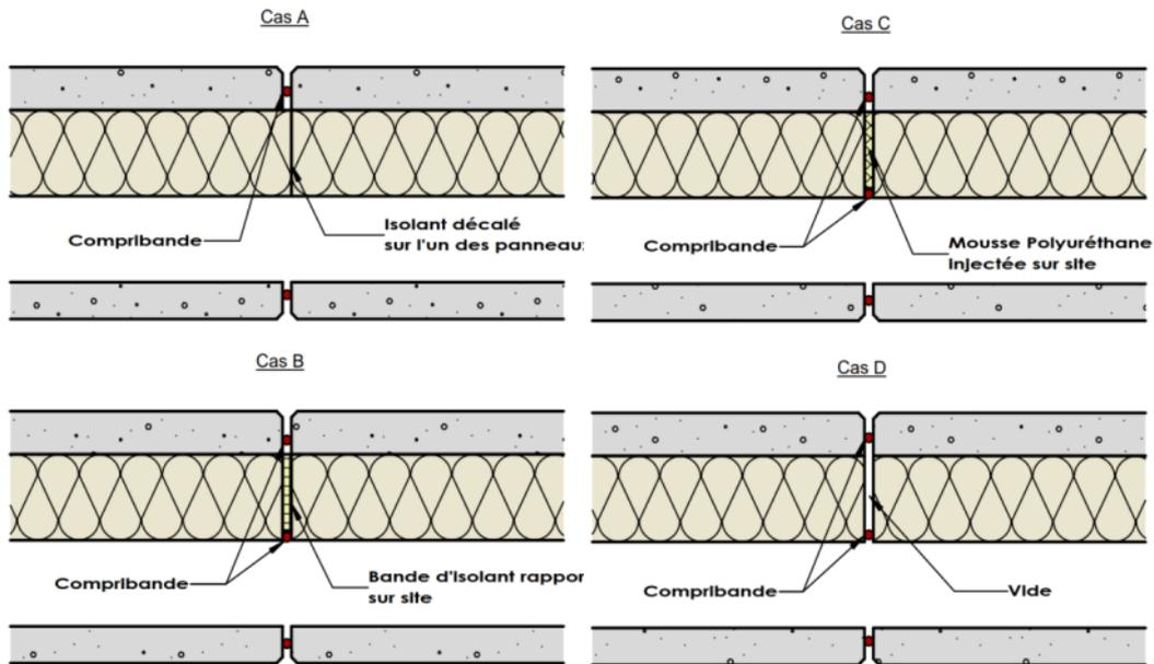
Figure 71 : Etanchéité à l'écoulement de laitance
