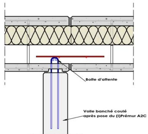
Figure 33 : Liaison en T entre un (i)Premur A2C et un mur coulé en place avec boîte d'attente.
