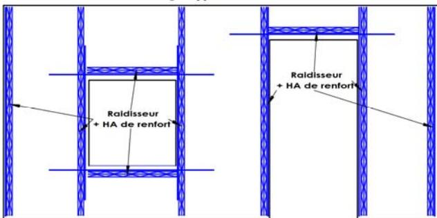
Figure 14 : Réalisation de chaînage en (i)Premur A2C
