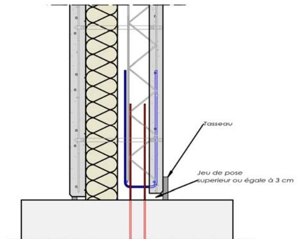
Figure 25 : Encastrement de l'(i)Prémur A2C/radier → Liaison de type Er1
