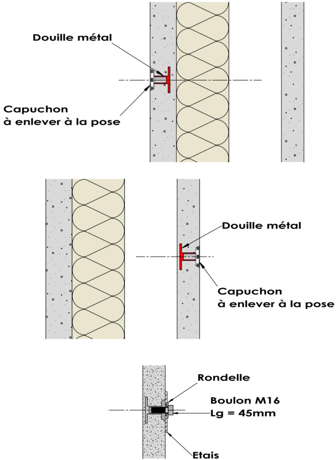
Figure 94 : Douilles métalliques incorporées dans l'(i)Premur A2C
