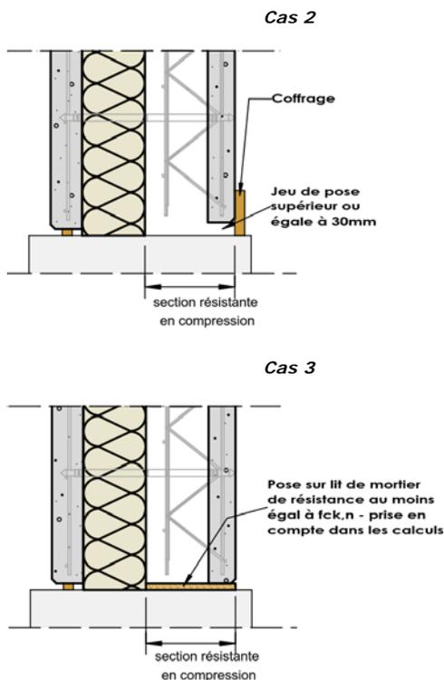
Figure 12 : Section résistante en compression en fonction du type d'appui
