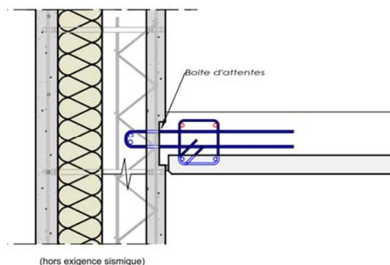
**Figure 29 : Liaison rotulée de l'(i)Premur A2C avec une dalle suspendue avec boîte d'attente (hors exigences de vérification sismique)**
