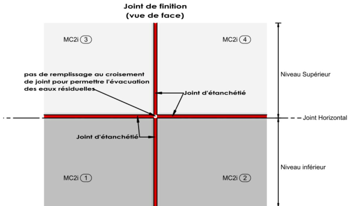
Figure 73 :: Traitement des joints verticaux et horizontaux
