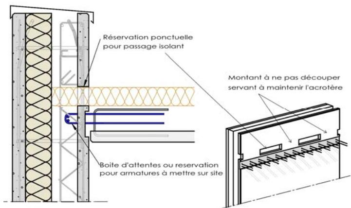
Figure 58 : Acrotères avec dalle suspendue – hors zone sismique
