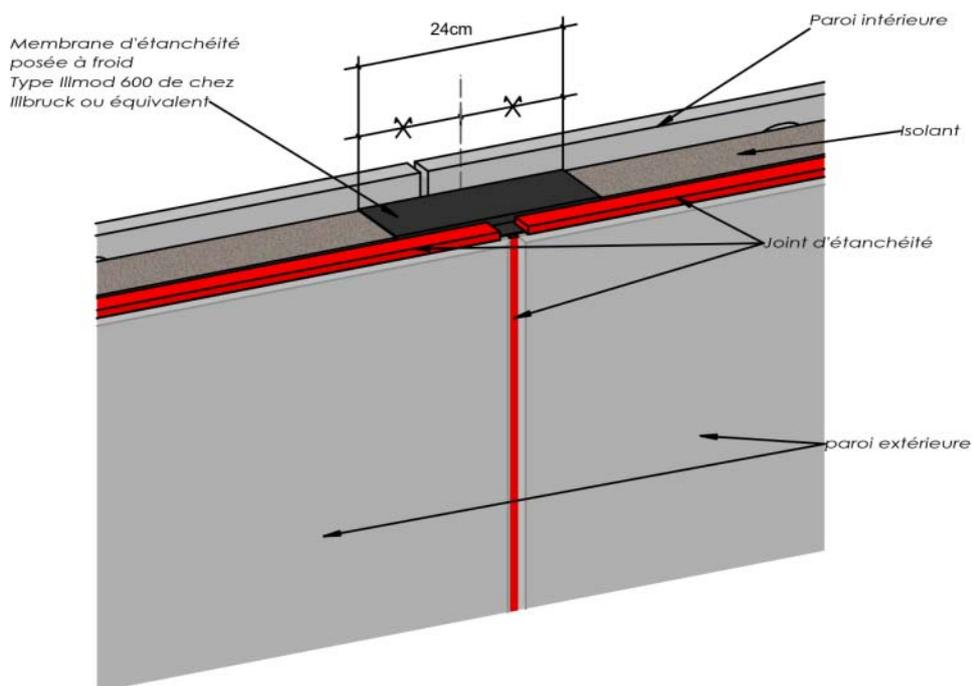
Figure 72 : Traitement des joints : Détails sur joints horizontaux
