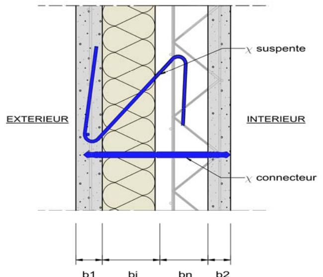
Figure 11 : Définition pour les calculs thermiques
