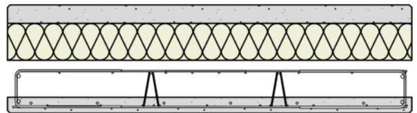
Figure 51 : Section de poteau résistant par le béton seul
