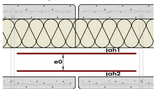
Figure 19 : Eclissage des armatures dans l'(i)Premur A2C
