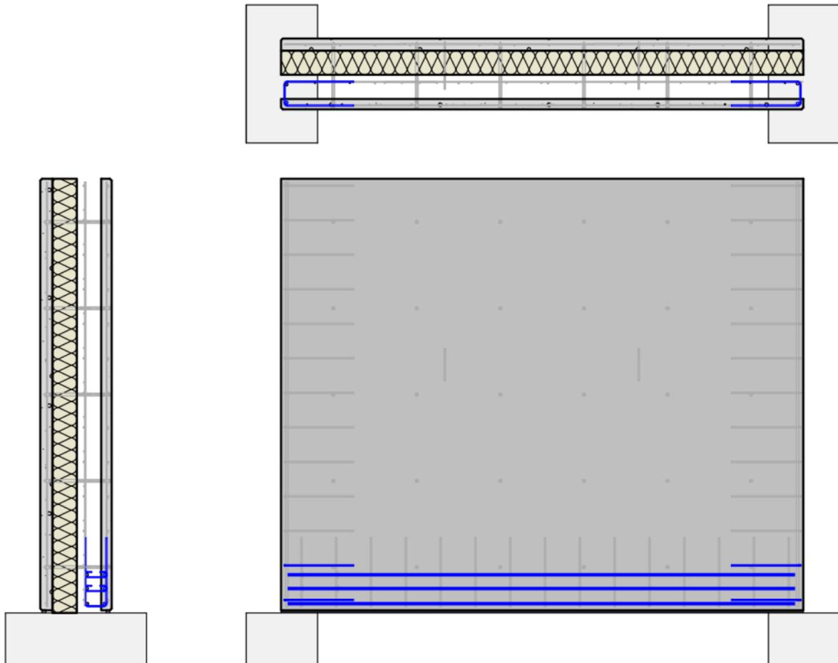
Figure 77 : poutre-voile en un seul élément
