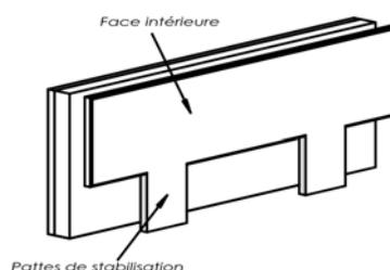
Figure 26 : Encastrement de l'(i)Prémur A2C/radier → Liaison Er2
