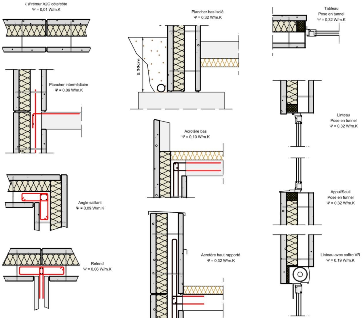
Figure 75 : coefficients de pertes linéiques
