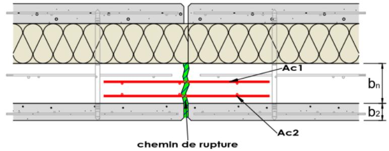
Figure 86 : plan de rupture 1
