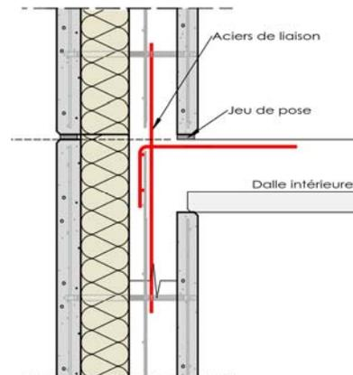
Figure 66 : Détails sur joints horizontaux : paroi extérieure au niveau de l'arase supérieure du plancher
