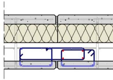
Figure 35 : Joint vertical encastré – Type de type Ev1
