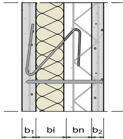
Figure 57 : Repérage des épaisseurs unitaires d'un (i)Premur A2C
