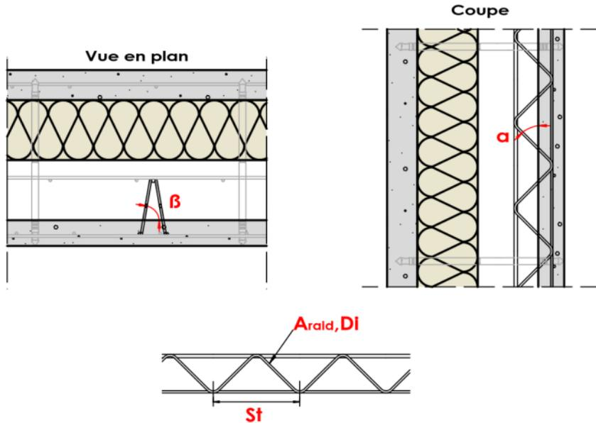
Figure 89 : Géométrie des raidisseurs type treillis Warren
