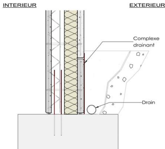
Figure 8 : Murs semi-enterrés
