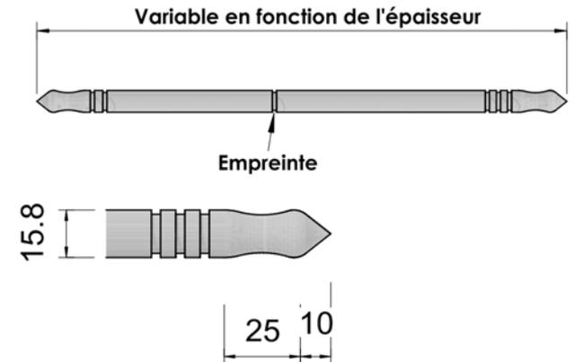
Figure 4 : Vue du connecteur - le diamètre courant de 15.8 mm et des gorges de 13 mm
