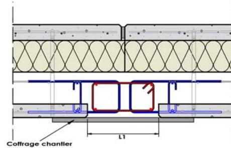
Figure 36 : Joint vertical encastré – Type Ev2
