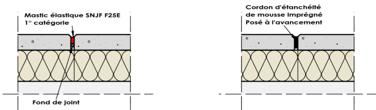
Figure 70 : Traitement du joint EXTERIEUR entre (i)Premur A2C
