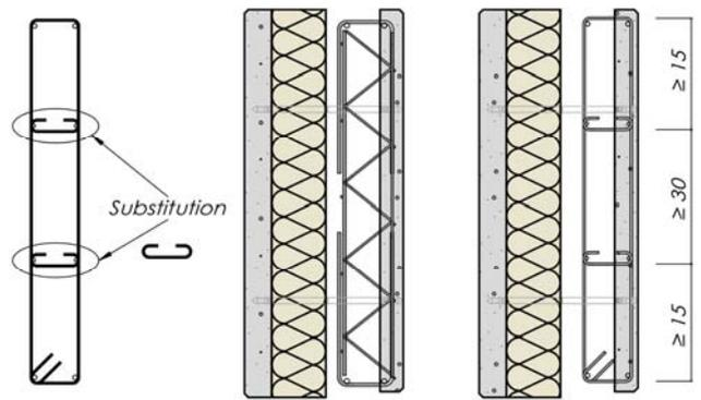
Figure 15 : Solution traditionnelle et de l'(i)Premur A2C
